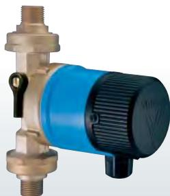
**Dans les pompes** d'eau chaude sanitaire avec carter de pompe V, le clapet anti-retour et le robinet d'arrêt à boisseau sphérique sont intégrés dans le carter de pompe. Les pompes possèdent un carter de pompe avec un filet extérieur R 1 1/4" pour les raccords. Elles sont équipées en série de raccords à visser 3/4" intérieurs.
